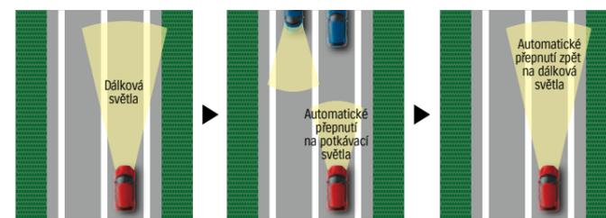
Pokud je to možné, dálková světla jsou zapnutá. Když systém zaznamená světla vozidla jedoucího vpředu nebo v protisměru, přepne na potkávací světla. Jakmile ostatní vozidla nejsou v dohledu, automaticky se znovu zapnou dálková světla.
