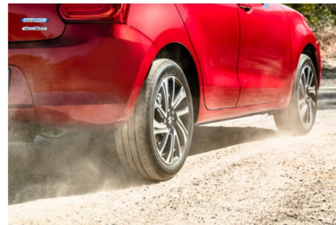
AllGrip AUTO je ideálním řešením pohonu všech kol pro řidiče, který potřebuje mít jistotu na kluzké silnici nebo ve sněhu. Základem je viskózní spojka, která zajišťuje plynulé připojení zadních kol ve chvíli, kdy ta přední začínají ztrácet trakci.
